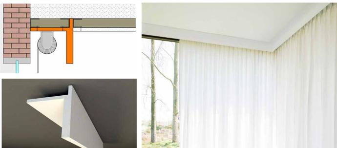
Cortinero en caso de nivel del cielorraso por encima de los dos barrales o rollos de cortina. APTO PARA MAMPOSTERÍA. Se puede colocar a cualquier altura respecto del cielorraso, prolongando con placa de yeso vertical hasta llegar al mismo. Dos barrales o rollos de cortina. Apto Backout.
