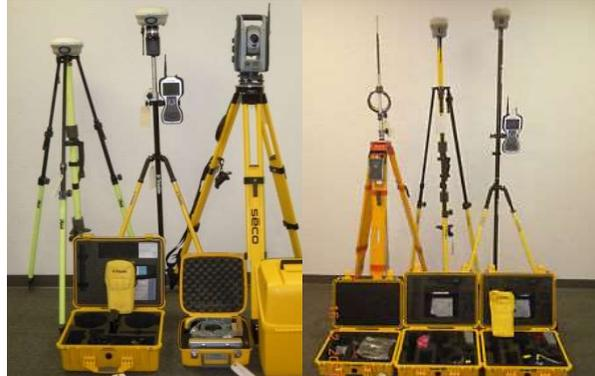
*GPS RTK R4, Estación Total y GPS RTK R10*
