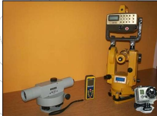
*Teodolito, Distanciómetro, Nivel y Cámara Go-Pro*
