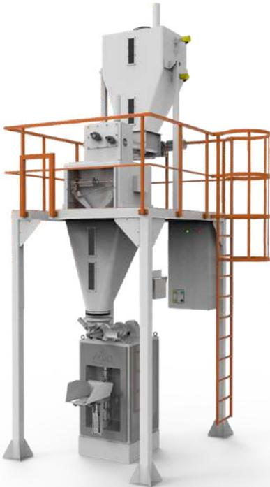
EMBOLSADORA VALVULADA LINEAL CON TURBINA, PARA BOLSAS DE 25 Y 50 KG. (CAPACIDAD 240 BOLSAS/HS DE 50 KG. Y 310 BOLSAS/HS DE 25 KG.)
