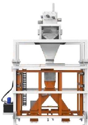
Equipado con una tolva superior con capacidad de 550 lts. Con cuplas para sensores de llenado máximo y mínimo. Cuenta con dosificador grueso y fino, balanza por bachadas con celdas de carga. También cuenta con una válvula guillotina para ajuste de peso y tolva inferior con acople cargador de Big Bag. Por su versatilidad este equipo puede cargar bolsones con productos tanto en polvos, granos, con sus dos bocas carga sobre camión, tiene una capacidad de 20 Tn/Hs.
