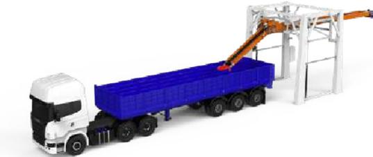
Este equipo cargador está compuesto de una cinta retráctil de 9.000 mm. También cuenta con una cinta de bajada de bolsas que es regulable en altura, tiene una longitud de 4.000 mm, paralelogramo deformable con bandeja de recepción y freno lateral de bolsas. Este tiene un cabezal de giro que realiza un barrido lateral sobre el camión. Su desplazamiento se realiza mediante cremalleras y equipamiento hidráulico con sistema de seguridad. Los motoredutores son de marca STM o Bomfiglioli.
