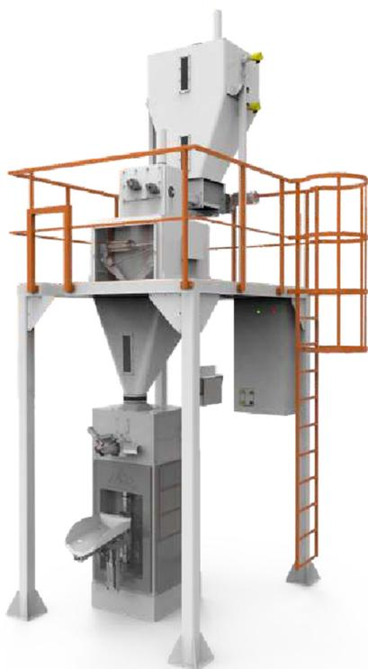
EMBOLSADORA VALVULADA LINEAL, CON AGITADOR PARA BOLSAS DE 25 Y 50 KG. (CAPACIDAD 240 BOLSAS/HS EN 50 KG Y 310 BOLSAS/HS EN 25 KG.)
