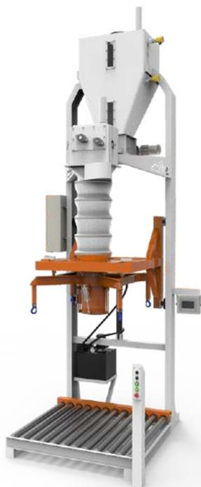
Este equipamiento carga bolsones desde 850 hasta 1.250 Kg. Es aplicable para productos en polvo y granos. Con una estructura fija, sostiene la tolva superior que tiene una capacidad de 550 Lts, con cuplas para sensores de llenado máximo y mínimo. Cuenta con un dosificador grueso y fino, válvula guillotina con cierre neumático. Posee una manga extensible con baldes cónicos y acople para aspiración.
