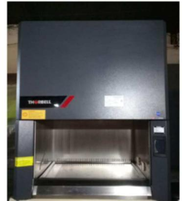
Piso removible para limpieza y esterilización con canales de captación en la zona lateral con terminación pulido mate para evitar reflejos.
