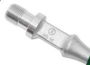
El acero HS96, diseñado para aplicaciones de bombeo de cargas extremas y bombeo (PCP) a cualquier profundidad que no exceda la tensión máxima permitida, está aleado y tratado térmicamente para maximizar su resistencia a la fatiga y mejorar su rendimiento en fluidos no corrosivos o en fluidos corrosivos efectivamente inhibidos. Este acero puede ser utilizado en algunas aplicaciones de bombeo convencional alternativo y progresivo PCP.
