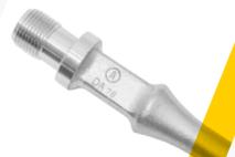
El acero DA78, diseñado para aplicaciones de bombeo convencional alternativo y progresivo PCP a cualquier profundidad que no exceda las tensiones máximas, está aleado y tratado térmicamente mediante un proceso que le confiere características únicas para maximizar su resistencia a la fatiga y mejorar su rendimiento en fluidos no corrosivos o efectivamente inhibidos. Este acero está indicado para aplicaciones de bombeo convencional alternativo y progresivo PCP.
