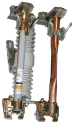
La incorporación de la cuchilla de cobre de hasta 300 A le brinda mayor versatilidad en la operación de la línea a proteger, ya que permite el reemplazo del elemento fusible cuando sea requerido, o realizar una maniobra aguas abajo del seccionador, sin la necesidad de hacer la tarea con tensión o dejando sin servicio a los usuarios que se encuentran conectados a ese ramal.
